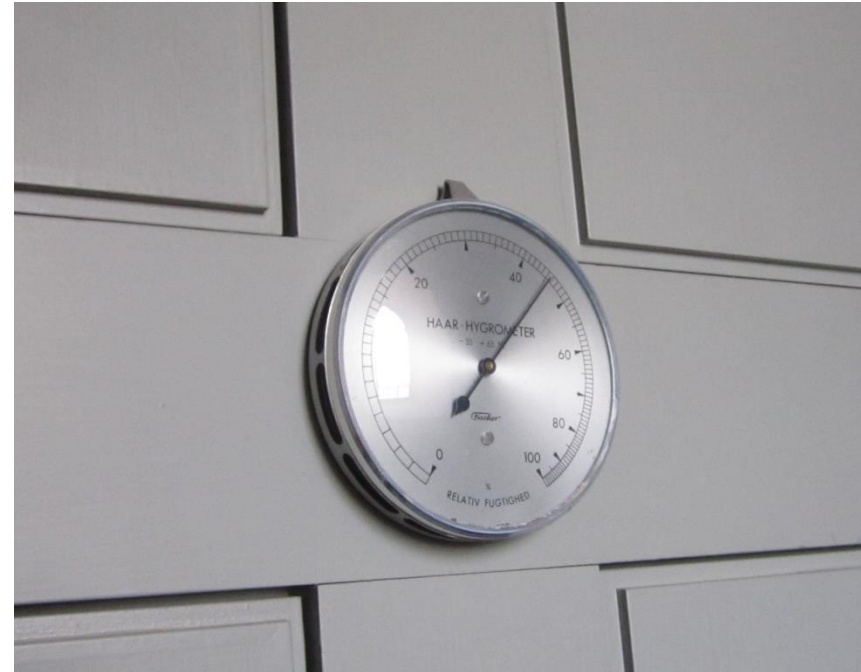
Et mekanisk hårhygrometer angiver den relative luftfugtighed (%RF). Alle boliger bør råde over et instrument til måling af relativ luftfugtighed.
